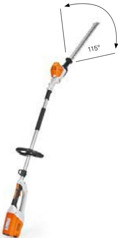
Akku-Heckenschneider für hohe und breite Hecken. Konstanter Messerhub unter Last, zusammenklappbar, ideal einstellbar für Kopf-, Seiten- und Bodenschnitt, um 115° schwenkbarer Messerbalken, lange Reichweite, doppelseitig geschliffene Messer, Transportlänge 125 cm, Gesamtlänge 205 cm.
