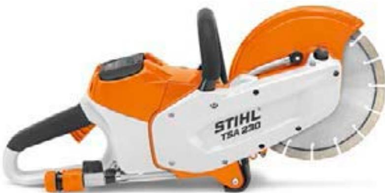
Handlicher Akku-Trennschleifer für 230-mm-Trennschleifscheiben zum Nass-Trennen. Innen und außen einsetzbar, Schnitttiefe bis 70 mm, Wasseranschluss mit Kugelhahn und Schlauchkupplung zum Nass-Trennen. Spindelarretierung, wartungsfreier Riemenantrieb.
