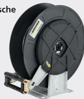
Vereinfacht das Handling des Hochdruckschlauchs, verkürzt Rüstzeiten und erhöht die Arbeitssicherheit. Selbstaufrollend, federgetrieben, für 20 m HD-Schlauch. Zur Wandmontage.
