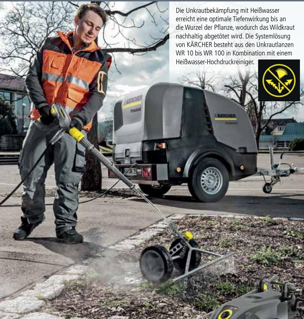
Die Unkrautbekämpfung mit Heißwasser erreicht eine optimale Tiefenwirkung bis an die Wurzel der Pflanze, wodurch das Wildkraut nachhaltig abgetötet wird. Die Systemlösung von KÄRCHER besteht aus den Unkrautlanzen WR 10 bis WR 100 in Kombination mit einem Heißwasser-Hochdruckreiniger.
