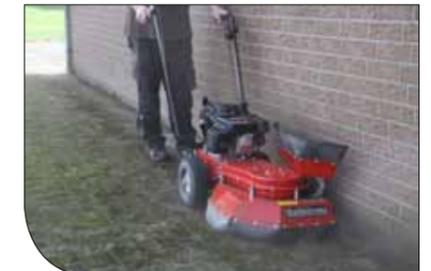
wandschlüssiges Arbeiten mit hochgeklapptem Rundumschutz
