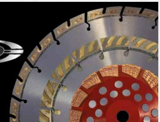
Die Diamanten sind ein integrierter Teil der Segmentstruktur. Während des patentierten Prozesses imprägniert eine spezielle Bindung die Kernstruktur und bindet dadurch die Diamanten in das Segment. Dieses Verfahren sorgt für eine maximale Auslastung der Diamanten, welche dem Werkzeug eine längere Standzeit ermöglicht.
