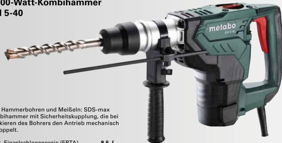
Zum Hammerbohren und Meißeln: SDS-max Kombihammer mit Sicherheitskupplung, die bei Blockieren des Bohrers den Antrieb mechanisch entkoppelt.
