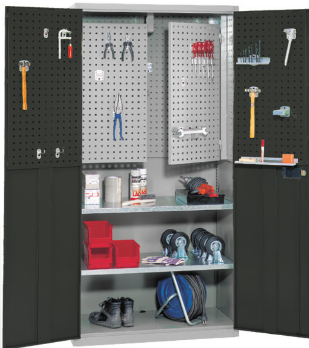
Stahllochplattenschrank 2000 x 1000 x 490 mm H x B x T mit abschließbaren Flügeltüren und folgender Innenausstattung: 2 verstellbaren Fachböden a' 80 kg Tragkraft bei gleich verteilter Last. 1 Rückwand mit System-Quadratlochung oben hinten montiert 2 Lochwände ca. 950 mm hoch, mit System-Quadratlochung Innen oben an den Türen montiert 2 Ausschwenktüren mit System-Quadratlochung ca. 950 mm hoch, oben eingebaut.
