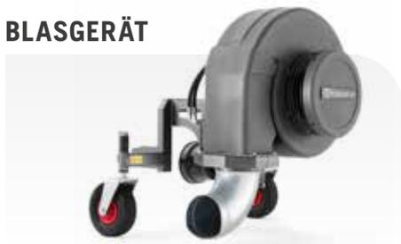
Zapfwellenbetriebenes Blasergerät zum Säubern von großen, offenen Flächen. Kraftvolles, geräuscharmes Gebläse mit einem Luftstrom von 80 m<sup>3</sup>/min. Vom Fahrersitz aus verstellbarer, 360 Grad Luftauslass. Erfordert Hydraulikkit.
