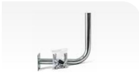
Halterung für EPOS™-Referenzstation. Abmessungen 300×250 mm, Durchmesser 32 mm. Für Wand- oder Mastbefestigung mit Ø30–60 mm. Stahl.
