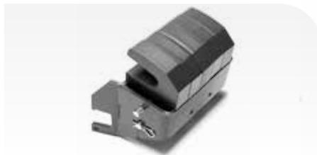
Heck-Gegengewicht für bessere Bodenhaftung und Stabilität. Muss bei der Bedienung einiger frontmontierter Anbaugeräte verwendet werden. Gesamtgewicht: 62 kg. Umfasst 5 x 10 kg stapelbare Einzelgewichte, die auf einem Rahmen (12 kg) aufgelegt werden können.
