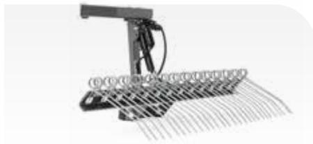
Heckmontiertes Zubehör, das zusammen mit der Schotterharke zum Begradigen von Kies/Schotter und zum Zusammenrechnen von Unkraut verwendet wird. Elektrisches Absenken und Anheben vom Fahrersitz aus möglich. Arbeitsbreite 125 cm.
