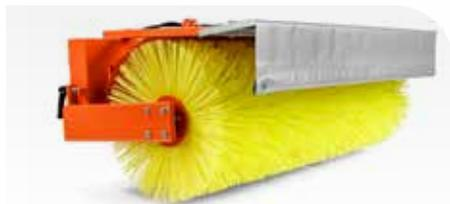
Zapfwellenbetriebene Kehrbürste zum gründlichen Entfernen von dünnen Schneedecken, Laub und Schmutz. Verstärkte Version mit größerem Durchmesser und erweiterter Winkeleinstellung. Arbeitsbreite 110 – 130 cm. Erfordert Hydraulikkit und Heckgewicht.
