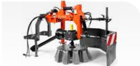
Zapfwellenbetriebene Wildkrautbürste zum gründlichen Entfernen von Unkraut und Schmutz aus Rinnen, von Gehwegen und an Bordsteinen. Der Bürstenwinkel ist vom Fahrersitz aus einstellbar. Durchmesser 50 cm. Erfordert Hydraulikkit und Heckgewicht.
