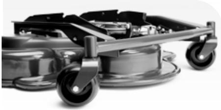
Das Husqvarna Combi-Mähdeck vereint eine sehr effiziente BioClip® Mulchfunktion mit Heckauswurf. Das robuste Bauteil wird aus einem 3 mm starken Stahlblech gestanzt. Zudem erhöht der optimierte Luftdurchsatz die Effizienz. Sie können zwischen den Mähbreiten von 112 cm oder 122 cm wählen.
