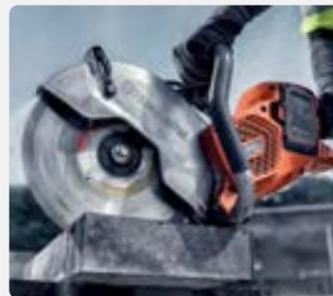
Unsere Diamanttrennscheiben für den Einsatz mit Akku-Trennschleifern sind so konzipiert, dass sie mit der Drehzahl des Geräts effektiv arbeiten und so den effizientesten Schnitt ermöglichen.
