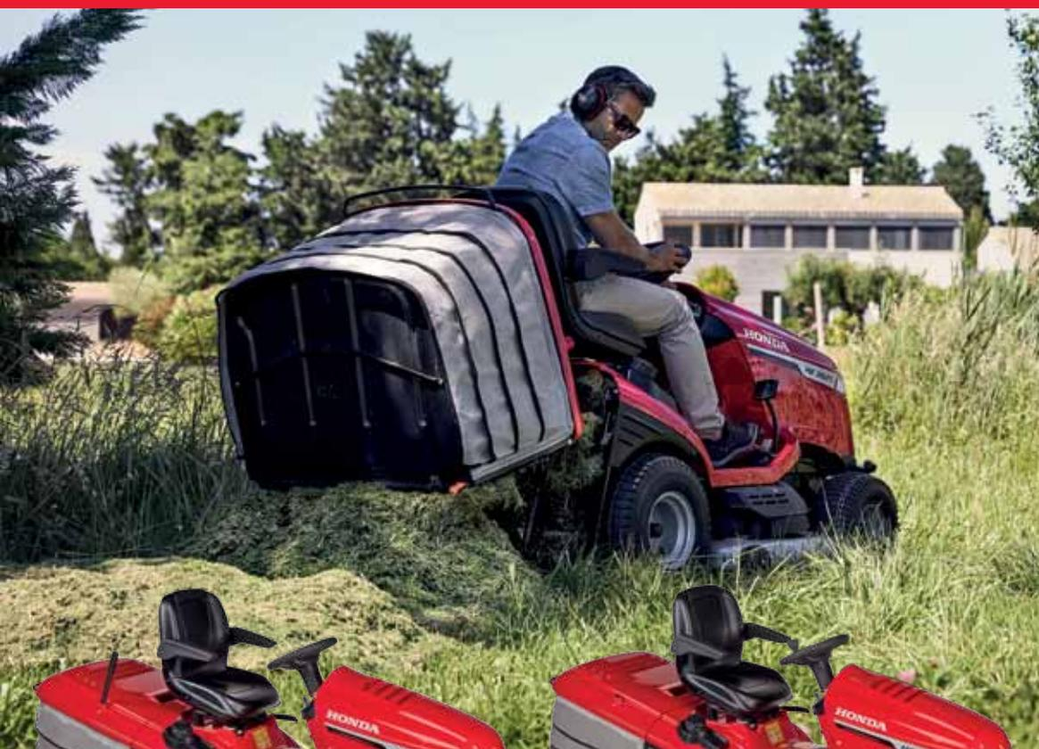
Die neuen Rasentraktor-Modelle bringen eine umfangreiche Komfortausstattung mit: Neben technischen Highlights wie dem stufenlosen Hydrostat-Getriebe und dem zuschaltbaren Versamow-Mulchsystem überzeugen Features wie das LED-Tagfahrlicht, LCD-Display, Tempomat, Handyfach und USB-Ladedose.
