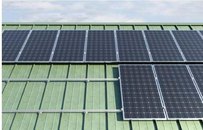
Mit den fischer Befestigungslösungen können aufgrund der flexiblen Schienen und Klemmen die Photovoltaikanlagen auf Steildächern mit Stehfalz-Eindeckung sowohl im Hoch- als auch im Querformat angebracht werden.
