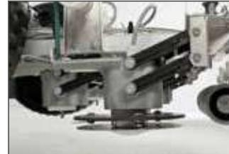
Jeder ECHO Mähroboter besitzt mehrere freischwebende Messerköpfe. Diese passen sich durch eine vertikale Bewegung automatisch der Geländestruktur an. Vorteile:
