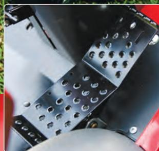
Die Wendigkeit des Frontmähers wird auch durch das stufenlose Hydrostatgetriebe unterstützt. Sie müssen nicht manuell schalten, sondern nur die Pedalwippe nach vorne oder hinten betätigen.
