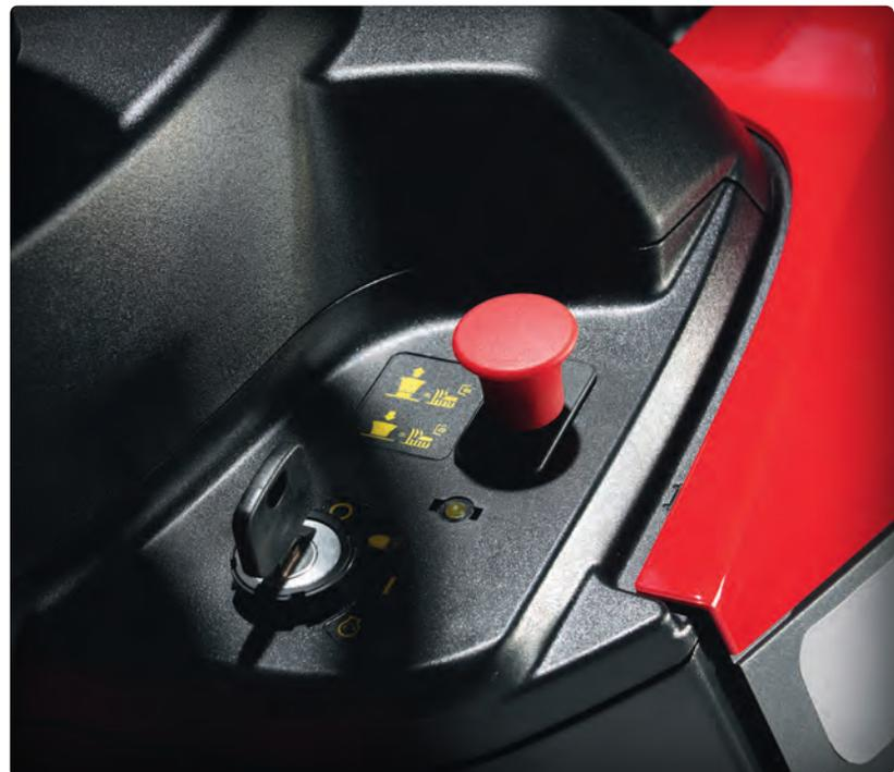
Für die Zuschaltung des Mähwerks setzen wir auf die sichere und unverwüsthliche Lösung der Elektromagnetkupplung. Per Push und Pull des Knopfes lassen sich die Messer im Handumdrehen zu- bzw. ausschalten.
