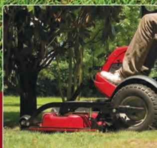
Mit einem Frontmähwerk erreichen Sie auch Flächen unter Büschen, in Ecken und nah Zäunen. Ein Nacharbeiten mit dem Trimmer wird auf ein Minimum reduziert.
