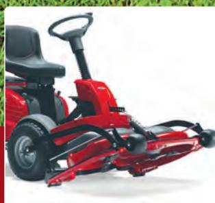
Das Frontmähwerk kann in eine Reinigungsposition verbracht werden, die es Ihnen ermöglicht, Grasreste vom Mähwerk leichter zu entfernen.
