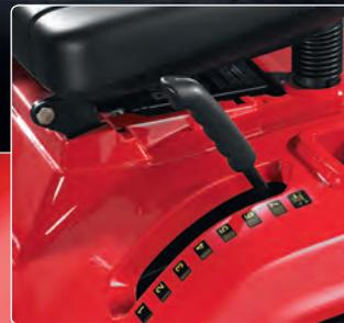
Es stehen bis zu 7 Schnitthöhen von 30 bis 80 mm zur Auswahl. Die Schnitthöheneinstellung erfolgt per Einhandhebel vom Fahrersitz aus.
