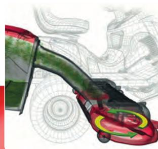
Die Rasentraktoren verfügen über ein exzellentes Fangverhalten. Das Schnittgut wird über einen großen Auswurfschacht in den Fangkorb befördert.
