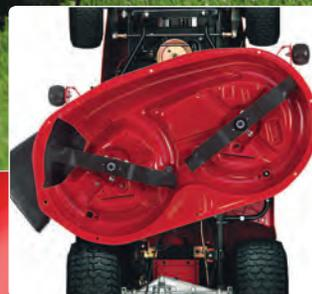
Speziell geformte Messer schneiden nicht nur das Gras, sondern unterstützen auch die Luftzirkulation für einen optimalen seitlichen Auswurf.
