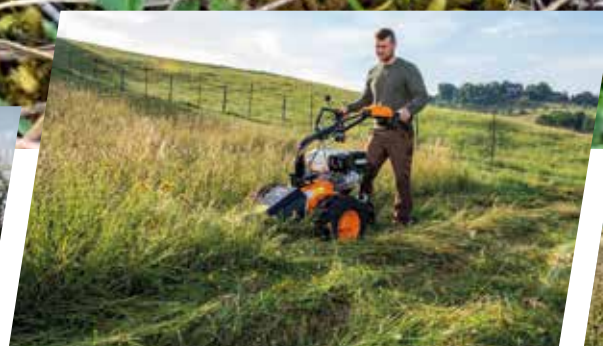
Schonender Schnitt mit Doppelmesser-Mähbalken
