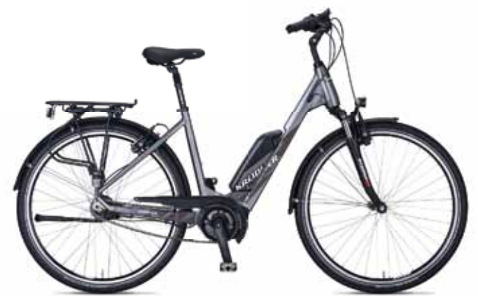
Vitality Eco 2 / Shimano Nexus 7-Gang FL oder RT / HS11 Antrieb: Bosch Active Line Akku: PowerPack 400 Wh UVP € 2.199,90 *
