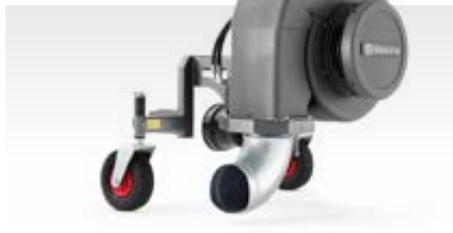
Zapfwellengetriebenes Blasgerät zum Säubern von großen, offenen Flächen. Kraftvolles, geräuscharmes Gebläse mit einem Luftstrom von 80 m<sup>3</sup>/min. Vom Fahrersitz aus verstellbarer, 360 Grad Luftauslass.
