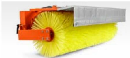
Zapfwellengetriebene Kkehrbürste zum gründlichen Entfernen von dünnen Schneedecken, Laub und Schmutz. Verstärkte Version mit größerem Durchmesser und erweiterter Winkeleinstellung. Max./Min. Arbeitsbreite 130/120 cm. Erfordert Hydrauliksat und Heckgewicht.
