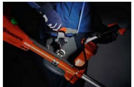
Schnelle Sicherheitsauslösung zur Trennung vom Arbeitsgerät (Wespenschutz).
