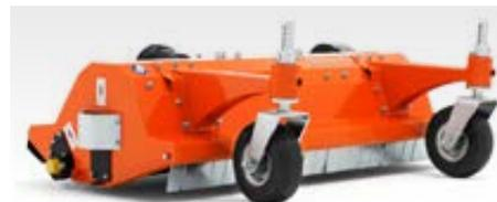
Zapfwellengetriebener Schlegelmäher. Überarbeitete Bauform mit verstärktem Kegelgetriebe, erweitertem Schritthöhenbereich und verbesserter Leistung bei dichter Vegetation. Die schwenkbaren Front-Laufräder sind pannensicher. Arbeitsbreite 120 cm. Nur für den Einsatz mit dem P 525D empfohlen. Erfordert Heckgewicht.
