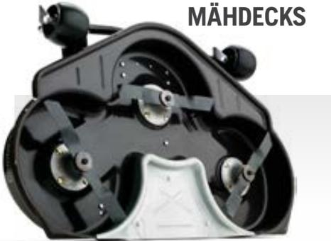
Die Husqvarna Kombi-Mähdecks vereinen eine sehr effiziente BioClip® Mulchfunktion mit Heckauswurf. Das robuste Bauteil wird aus einem 3 mm starken Stahlblech gestanzt, was zu einer hohen Effizienz dank des optimierten Luftdurchsatzes beiträgt. Sie können zwischen Mähbreiten von 112 cm oder 122 cm wählen.
